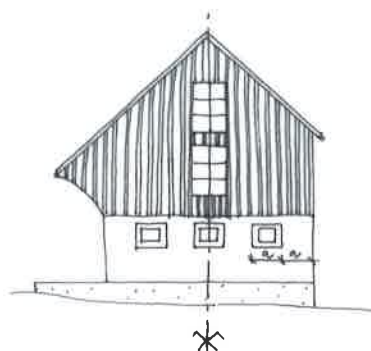
Création de fenêtres supplémentaires en soubassement et dans le bardage : elles s'inspirent des dimensions de portes de fenil et des fenêtres existantes et s'ordonnent selon une composition régulière
